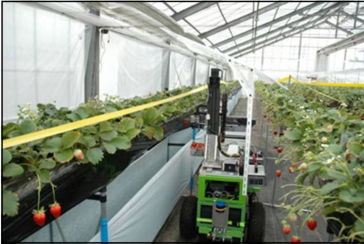
شکل ۱-۱- Harverst Croo، ربات برداشت توت‌فرنگی
