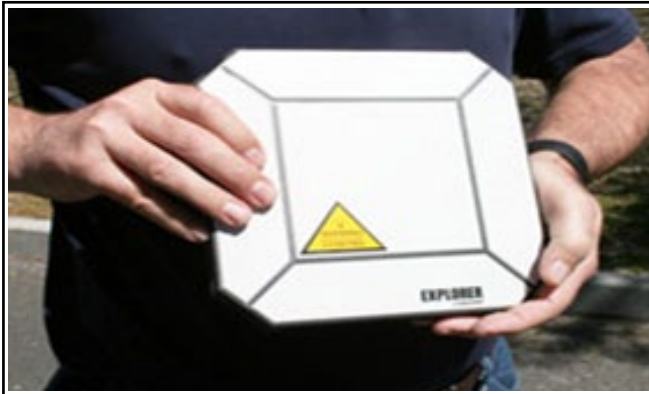
شکل ۸: دستگاه‌های گیرنده اینترنت ماهواره‌ای دستی مدل Explorer 510
