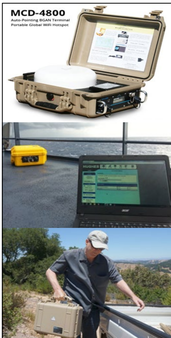
شکل ۹: دستگاه گیرنده اینترنت ماهواره‌ای خودکار مدل MCD-4800
