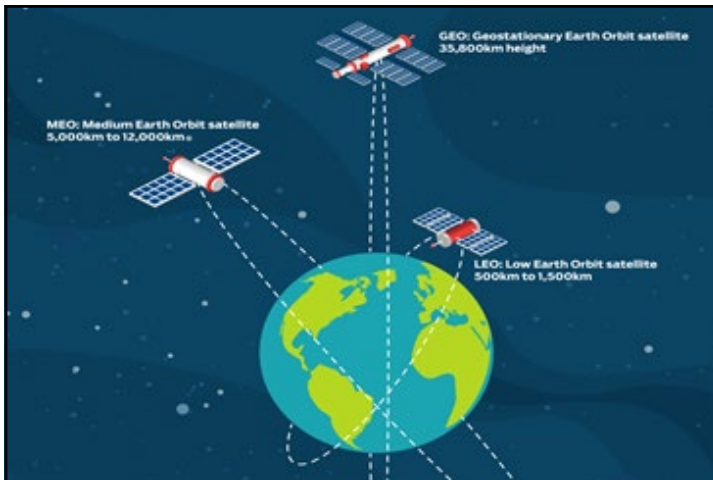
شکل ۴: انواع مدارهای دور زمین
